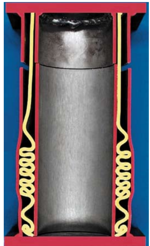
Schnitt durch ein gestauchtes AT - LSC-Stachelement
