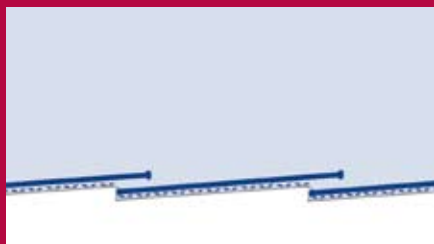
Einfacher Rohrschirm mit Ortsbrustentwässerung
